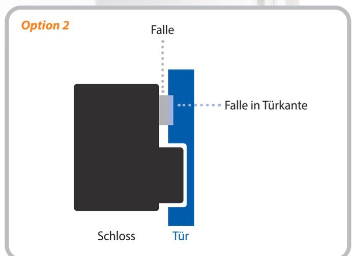
Einfassung in die Türleiste für die abgesetzte Antenne, **kein Schließteil** erforderlich da die Falle in der Türkante greift. (Referenzprojekt PJZ)
