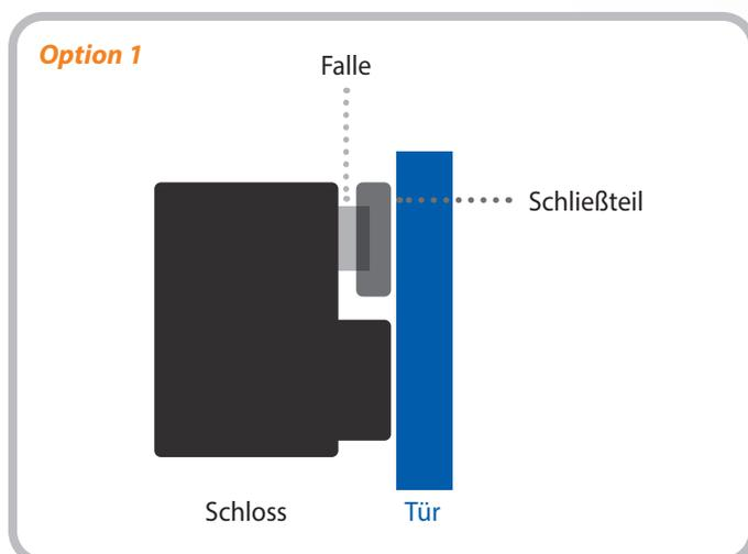
Schloss wird zurückversetzt platziert, die Antenne ist fast bündig mit der Türinnenseite (0,5 mm Abstand). Ein Schließteil sorgt für die Verriegelung.
